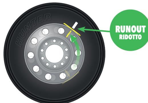
Le vibrazioni relative al runout sono ridotte al minimo, garantendo al tuo cliente una guida più fluida.
