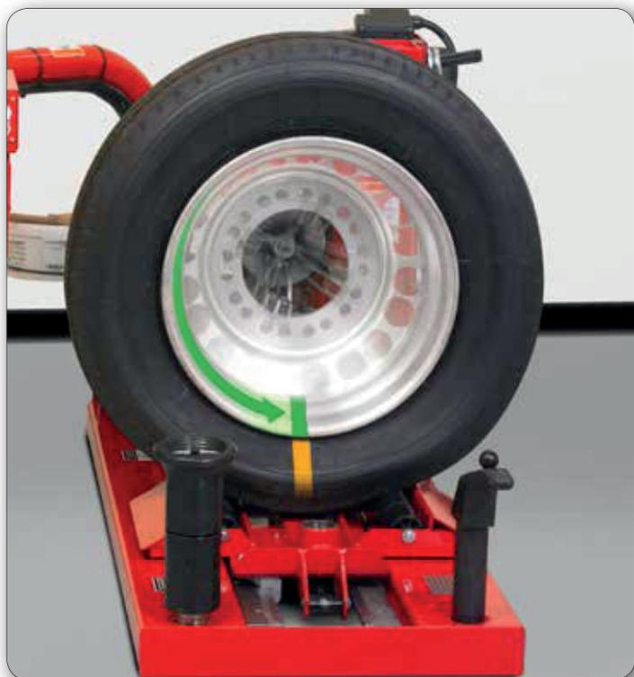
In combinazione con l'equilibratrice ForceMatch® (a destra), il TCX625 offre la possibilità di match-mounting per ottenere una guida più fluida possibile
