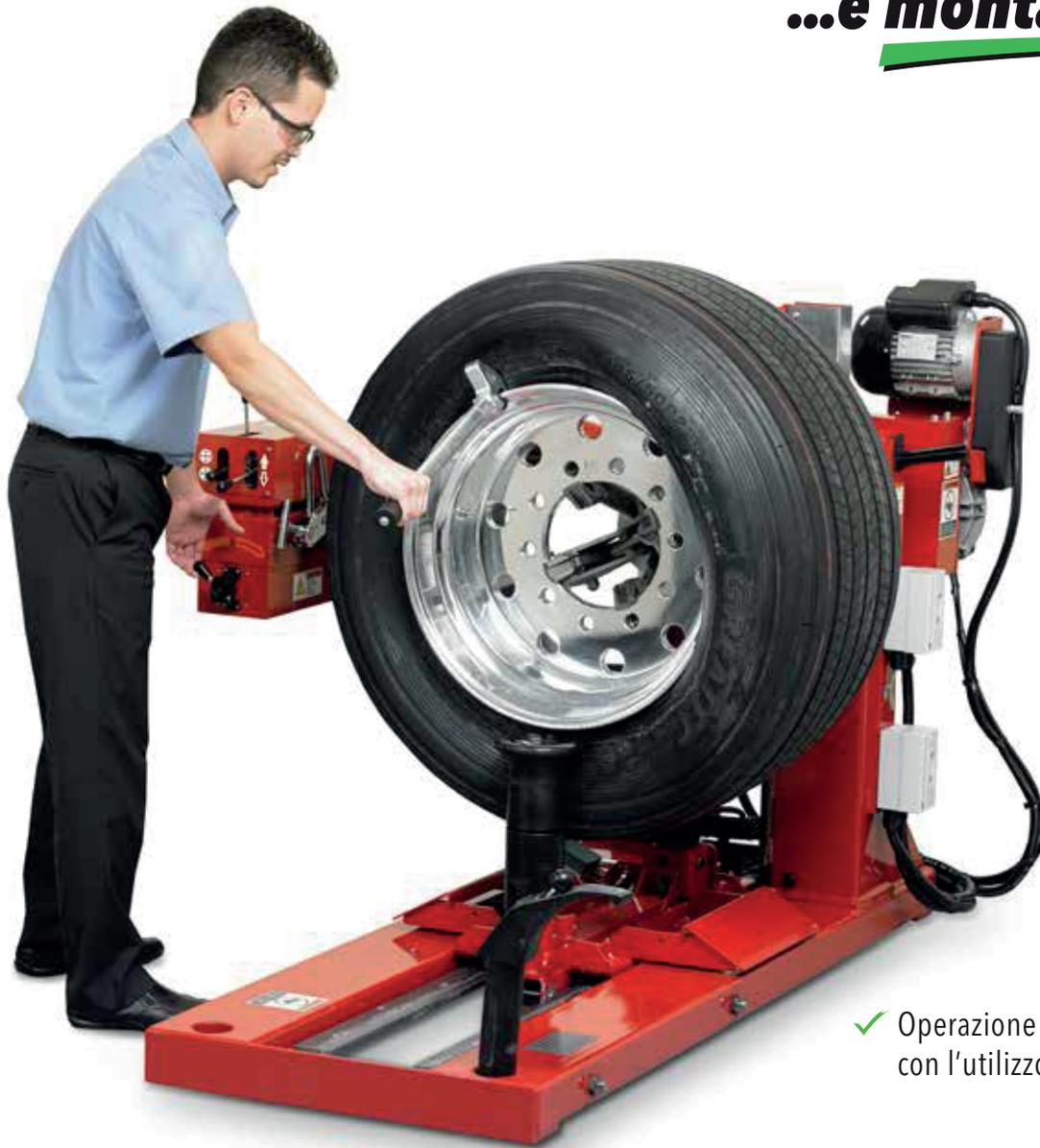
✓ Operazione di montaggio eseguita con l'utilizzo della leva (optional)
