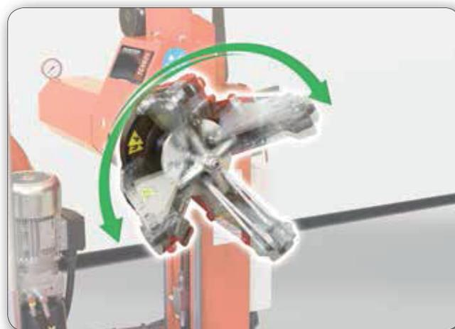
L'innovativo morsetto idraulico si espande e si contrae rapidamente, bloccando lo pneumatico e permettendo il montaggio rapido di ruote di tutte le dimensioni.
