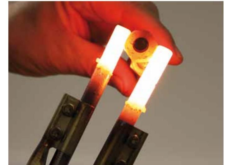
Rispetto al gas, questo metodo è più efficiente perché la corrente riscalda il materiale dall'interno. Il gas riscalda la superficie e il calore viene distribuito anche ai componenti. Il fatto che sia più facile raggiungere il luogo in cui è necessario riscaldare aumenta anche la versatilità dello strumento.
