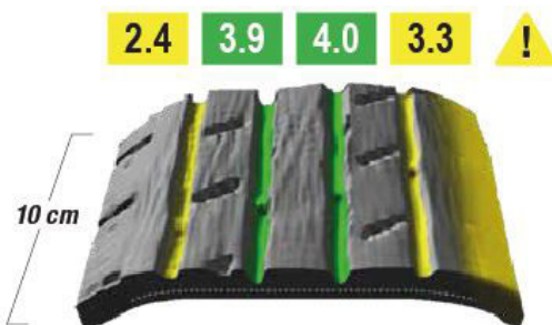
Misurazione precisa della profondità del battistrada, calcolata per ogni scanalatura
