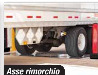
Il sistema d'ispezione senza contatto, per mezzi pesanti, di Hunter, fornisce risultati di convergenza totale, scrub e profondità del battistrada, in pochi secondi, anche su configurazioni multi-rimorchio e pneumatici super-single.
