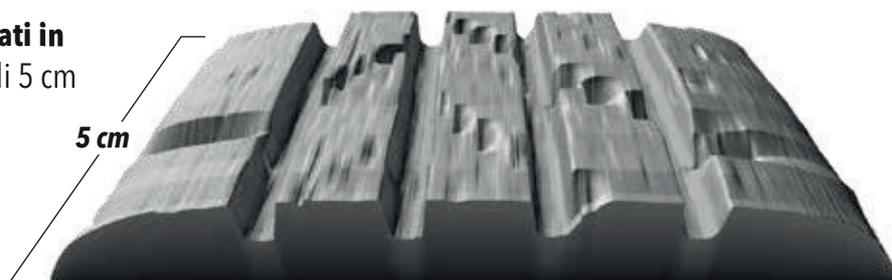
Risultati visualizzati come modello 3D dello pneumatico
