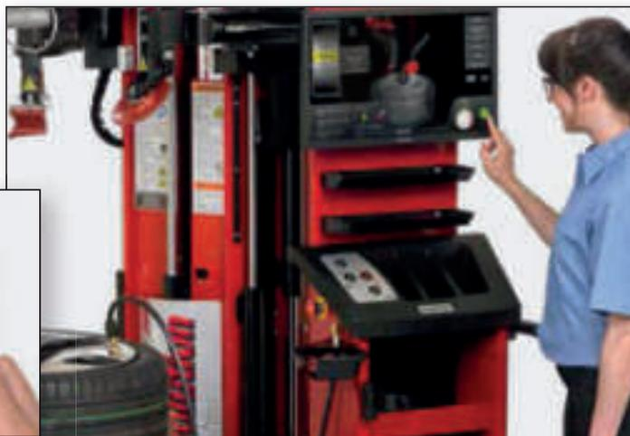
*Gonfiaggio rapido ad alta pressione dirige una grande quantità d'aria all'interno dello pneumatico consentendo un posizionamento ottimale del tallone*
