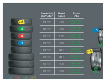
EXCLUSIVE TranzSaver™ Confronta le circonferenze degli pneumatici, come specificato dai costruttori per prevenire danni ai veicoli a trazione integrale (AWD)
