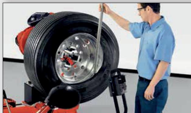
L'utensile di montaggio, standard, viene utilizzato per il montaggio/smontaggio di pneumatici tubolari e super single, o altre ruote difficili da maneggiare.
