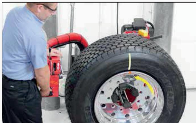
Quando si combina l'equilibratrice HD Elite™ (a sinistra) con uno smontagomme per impieghi gravosi (a destra), la loro capacità di match-mounting consente di ottenere una guida il più fluida possibile.
