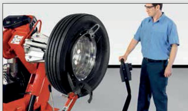
Posizionare le pinze per ruote e stallonare il primo tallone. Riposizionare le pinze e procedere con il secondo.
