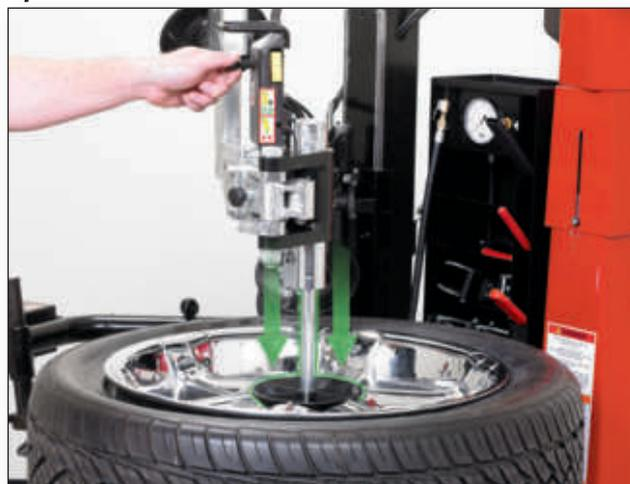
Coni per ruote e braccio di estensione semplificano il serraggio esterno, durante la manutenzione di pneumatici a basso profilo.
