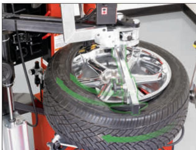
Un singolo rullo premitallone, con braccio rotante, può montare e smontare rapidamente pneumatici con fianco rigido.
