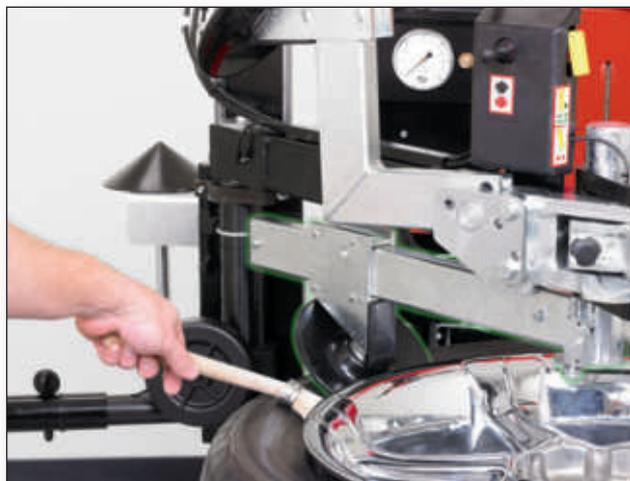
I dischi conici aiutano la lubrificazione del tallone e facilitano lo smontaggio.
