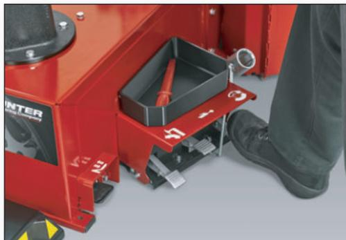
*Gonfiaggio, rotazione e sollevamento ruote sono controllati dai pedali.*
