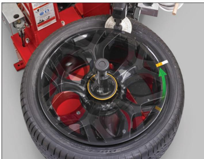
I dischi stallonatori del TCX70 permettono la rotazione dello pneumatico sul cerchio, agevolando la procedura di match mount della ruota.
