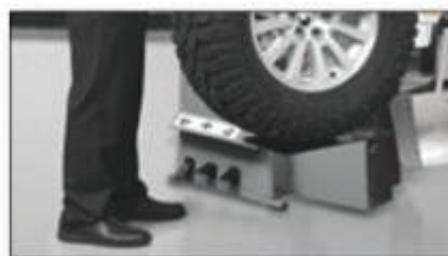
*Sollevatore ruota (optional) per ruote fino a 100kg*
