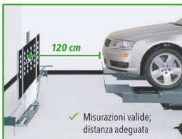
Misurazione del sistema adattivo della velocità (ACC) o regolazione automatica della distanza (ADR) utilizzando le telecamere opzionali con radar HE421 (20-2814-1).
