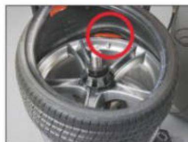
*Quando il diametro del cerchio e la posizione della valvola sono stati memorizzati, si evita il danneggiamento del sensore TPMS*
