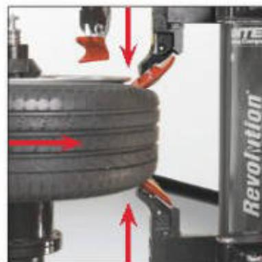
*Lo stallonatore ruota e simultaneamente spinge delicatamente lo pneumatico facendo pressione sopra e sotto il cerchio senza danneggiare il sensore TPMS*
