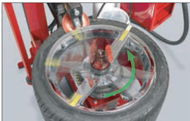
I dischi stallonatore dello smontagomme Maverick™ permettono la rotazione del pneumatico sul cerchio, aiutando il corretto match-mounting
