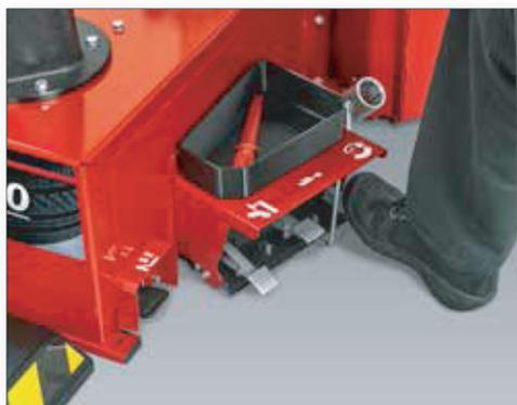
*Le operazioni di gonfiaggio, rotazione e oscillazione della colonna, sono controllate tramite i pedali*
